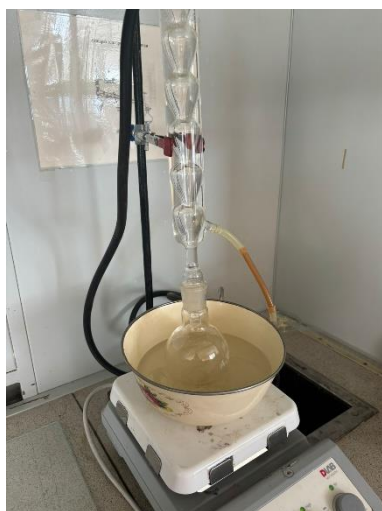
Рисунок 5 – Водяная баня (с обратным холодильником) и термометр
